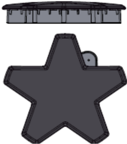
Figura 14: Tapa de quemador colocado correctamente
