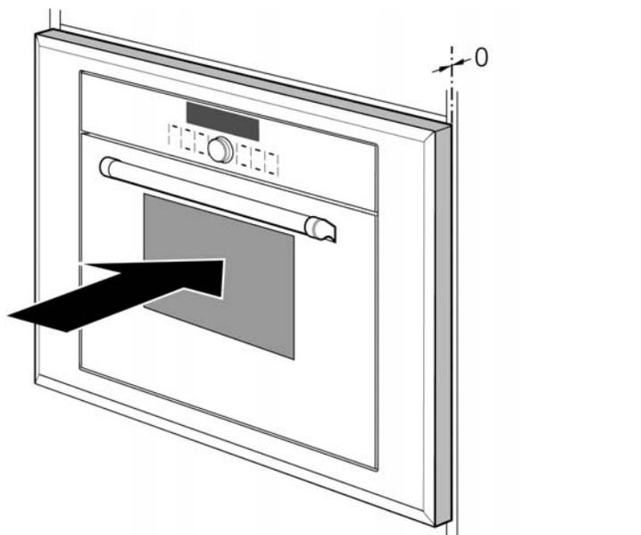
Régler la position de l'appareil à l'intérieur de l'armoire
