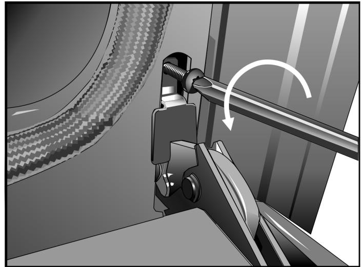
5. Après avoir retiré la vis, (A) soulever la plaque de verrouillage et la faire pivoter pour l'enlever. Répéter l'opération pour l'autre charnière. Conserver les plaques de verrouillage et les vis pour réinstaller la porte.
