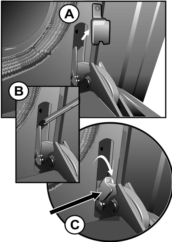
7. Avec les genouillères bien en place, tel que montré dans l'illustration, fermer doucement la porte du four jusqu'à ce que la face avant de la porte se trouve à 5 1/2 pouces (140 mm) du panneau de contrôle.
