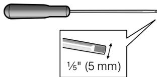
Tournevis à lame plate étroite (lame de 1/8 po (5 mm) ou moins de largeur adaptée à l'encoche).
