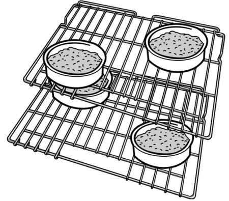
Disposition des ustensiles de cuisson dans les appareils électroménagers de 30 po (76,2 cm).
