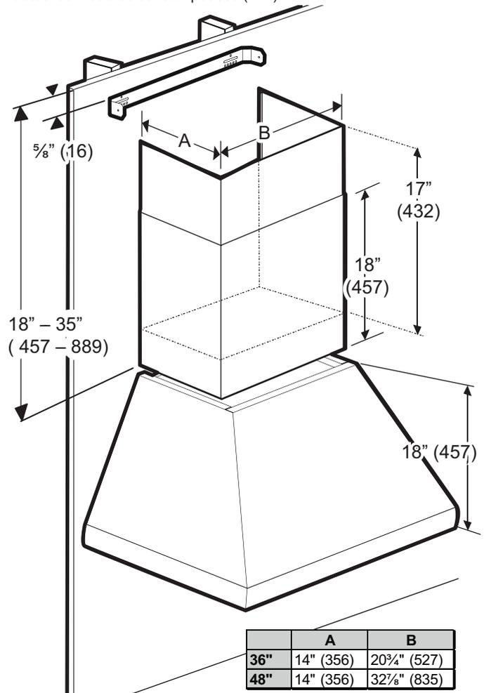
3. Le long des montants, mesurez 5/8 po (16 mm) entre le plafond et le dessus du support.
