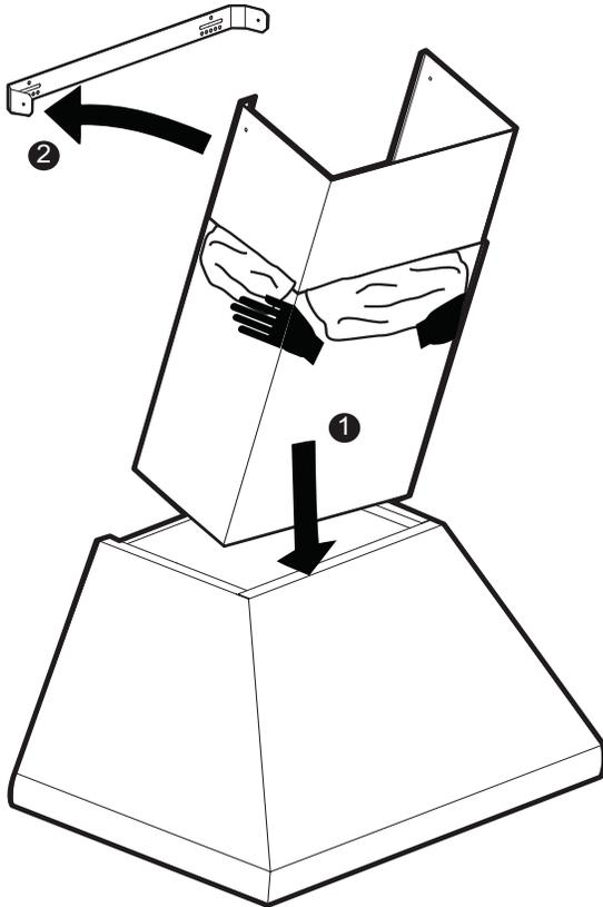
7. Empuje cuidadosamente la parte superior del alargador hacia arriba. Atornille los lados izquierdo y derecho del alargador al soporte de montaje con los tornillos para acero inoxidable proporcionados.
