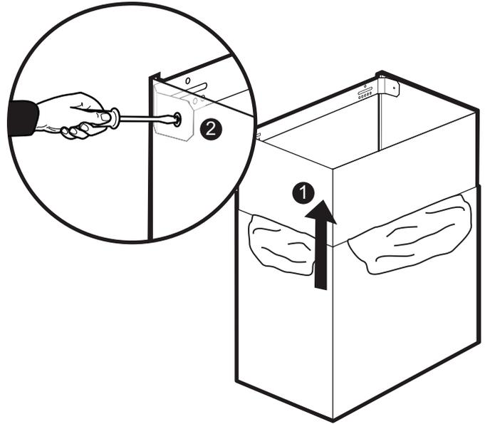
8. A partir del interior de la campana, atornille los tornillos para chapa de 5/8 pulg. (16 mm) proporcionados a través de los agujeros de cada lado y de la parte delantera del alargador. La cantidad de tornillos depende del tamaño de la campana.
