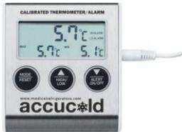
Ce thermomètre numérique affiche simultanément les températures maximales, minimales et actuelles. La fonction Max / Min surveille et stocke les lectures les plus hautes et les plus basses depuis l'insertion de la batterie ou depuis la dernière pression sur la touche RESET.
