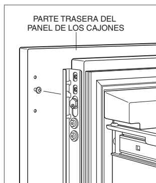
Montaje del panel del cajón.
