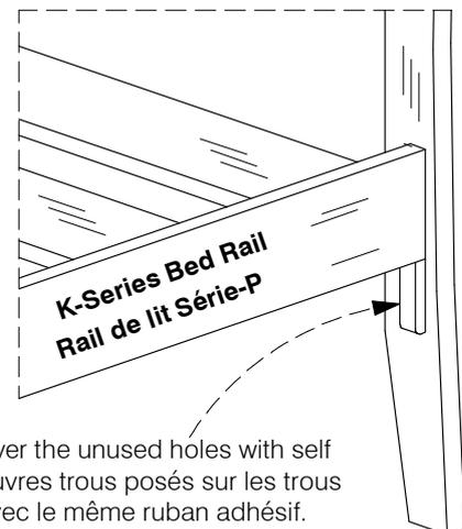
The Cover Block fixes over the unused holes with self adhesive tape. / Les couvre trous posés sur les trous non utilisés sont fixés avec le même ruban adhésif.
