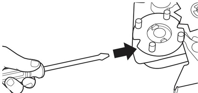
5. Placer une nouvelle came (axe vers le bas) sur l'arbre de l'horloge. Aligner le côté plat de l'arbre avec le côté plat du trou de la came. Vérifier que la patte d'attache est en place.
