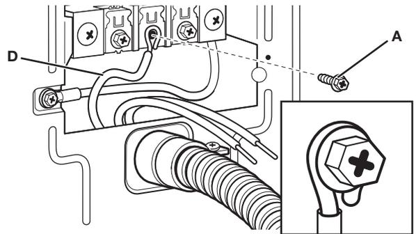
3. Placer les extrémités en crochet des conducteurs à raccordement direct (crochets orientés vers la droite). Rapprocher les extrémités en crochet et serrer les vis extérieures du boîtier (F). Enfin, réinstaller le couvercle du bornier et serrer la vis de retenue. Resserrer les vis. Passer à la section "Achever l'installation".
