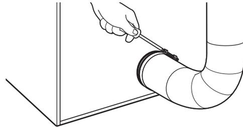
4. S'assurer que le conduit d'évacuation est fixé au clapet d'évacuation à l'aide d'une bride de fixation de 4 po (102 mm).
