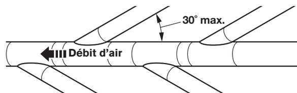
L'inclinaison maximale de chaque conduit qui pénètre dans le conduit principal ne devrait pas dépasser 30°.
