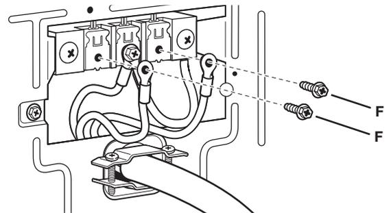
4. Raccorder un autre conducteur de terre en cuivre (G) sous la vis de conducteur de terre externe (C) pour mise à la terre adéquate. Enfin, réinstaller le couvercle du bornier et serrer la vis de retenue. Passer à la section "Achever l'installation".
