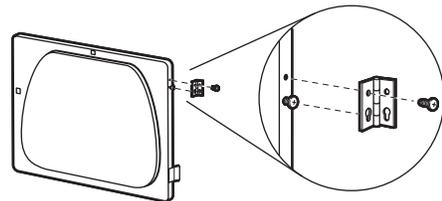
10. Ôter les 4 vis fixant les 2 bouchons d'obturation du côté gauche. Fixer les bouchons d'obturation sur le côté droit à l'aide des mêmes 4 vis.
