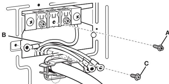
2. Connecter le conducteur de mise à la terre neutre (B) et le conducteur neutre (blanc ou central) (D) à la borne centrale du bornier. Serrer la vis.
