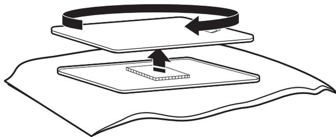
7. Veiller à maintenir la cale d'espacement en carton centrée entre les portes. Fixer à nouveau le panneau de porte à la porte interne de façon à ce que la poignée se trouve du côté où les vis viennent d'être retirées.
