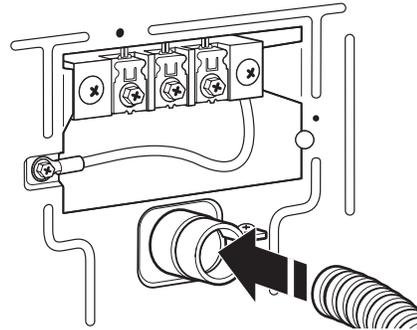
Passer le câble à raccordement direct à travers le serre-câbles. Le serre-câbles doit être bien relié à la caisse de la sécheuse et se trouver en position horizontale. Serrer la vis du serre-câbles autour du câble à raccordement direct.
