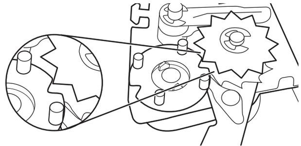
7. Pousser la came en place vers le bas sur l'arbre de l'horloge. S'assurer que l'encoche en V soit dégagée de la roue dentée.
