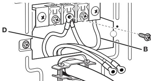
3. Connecter les conducteurs restants sous le bornier extérieur. Resserrer les vis (F).
