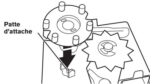
6. Tourner la came jusqu'à ce que l'encoche en V s'aligne avec la roue dentée.
