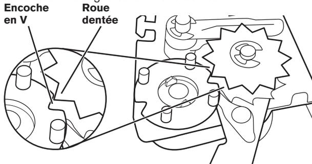
4. Insérer un tournevis à lame plate mince sous la roue dentée près de l'arbre de l'horloge. Soulever doucement et en ligne droite la came de minutage en s'assurant que l'encoche en V est dégagée de la roue dentée.
