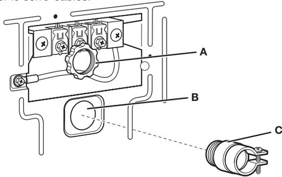
Dévisser le raccord de conduit amovible (A) et les vis d'un serre-câbles homologué UL (inscription UL sur le serre-câbles) de 3/4 po (19 mm). Visser la partie filetée du serre-câbles (C) dans le trou sous l'ouverture du bornier (B). En passant par l'ouverture du bornier, visser le connecteur de conduit amovible (A) sur le filetage du serre-câbles.
