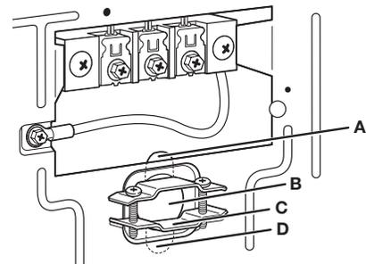
Retirer les vis d'un serre-câbles homologué UL de 3/4 po (19 mm) UL (inscription UL sur le serre-câbles). Placer les languettes des deux moitiés de pince (C) dans le trou sous l'ouverture du bornier (B), de sorte qu'une d'entre elles pointe vers le haut (A) et l'autre vers le bas (D). Maintenir en place. Serrer les vis du serre-câbles juste assez pour maintenir ensemble les deux moitiés de pince (C).
