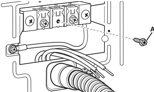
2. Placer l'extrémité en crochet (crochet orienté vers la droite) du conducteur neutre (blanc ou conducteur central) (D) sous la vis de la borne centrale (A). Rapprocher les extrémités du crochet. Serrer la vis.
