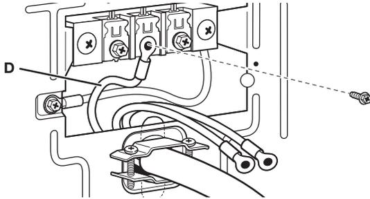
3. Connecter les conducteurs restants au moyen des vis les plus à l'extérieur du bornier (F). Serrer les vis du serre-câbles sur le cordon d'alimentation. Enfin, réinstaller le couvercle du bornier et serrer la vis de retenue. Passer à la section "Achever l'installation".
