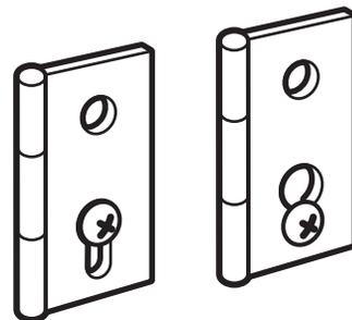
12. Fermer la porte et vérifier que la gâche de la porte est alignée avec le piton de retenue de la porte. Au besoin, faire glisser le piton de retenue de la porte vers la gauche ou vers la droite à l'intérieur de l'encoche pour régler l'alignement.
