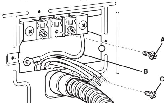
1. Connecter le conducteur de terre neutre (B) et placer l'extrémité en crochet (crochet orienté vers la droite) du conducteur neutre (D) (blanc ou conducteur central) sous la vis de la borne centrale (B). Rapprocher les extrémités du crochet. Serrer la vis.
