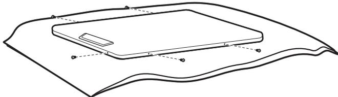
6. Tout en maintenant la porte sur une serviette et sur la sècheuse, saisir les côtés de la porte externe et soulever doucement pour la séparer de la porte interne. Ne pas utiliser un couteau à mastic pour séparer les parties. Ne pas tirer sur le joint ou le piton de retenue en plastique de la porte.
