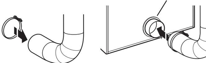
3. Serrer la bride de serrage de tuyau avec un tournevis cruciforme.
