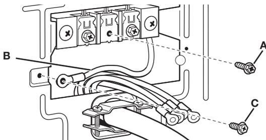
2. Connecter le conducteur de terre neutre (B) et le conducteur neutre (blanc ou central) (D) du cordon/câble d'alimentation sous la borne centrale du bornier. Serrer la vis.
