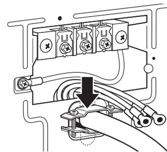
Passer le cordon d'alimentation à travers le serre-câbles. Vérifier que la gaine d'isolation du cordon d'alimentation rentre à l'intérieur du serre-câbles. Le serre-câbles doit être bien relié à la caisse de la sècheuse et se trouver en position horizontale. Ne pas visser davantage les vis du serre-câbles à ce stade.
