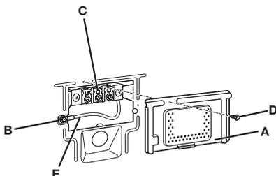
Avant de commencer, débrancher l'alimentation. Retirer la vis de retenue (D) et le couvercle du bornier (A).
