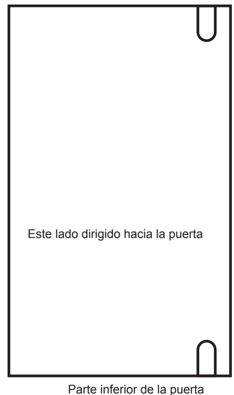
Figura 42 Dimensiones del panel para una puerta con bisagras en el lado izquierdo
