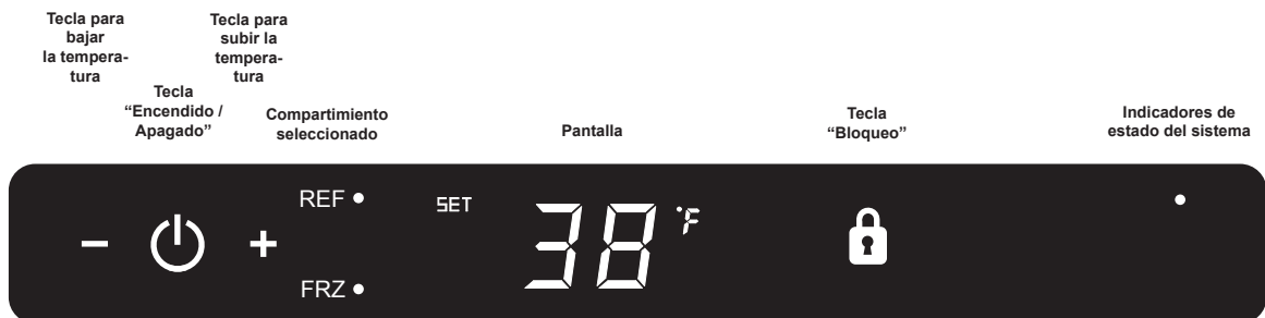
Figura 12 Control electrónico para una sola zona
