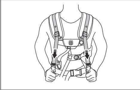
11. Régler les courroies latérales autour de la cage thoracique jusqu'à ce que le plastron s'aligne avec le centre de votre poitrine.
