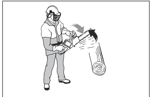
Utilice el freno de cadena como freno de estacionamiento cuando arranque el producto y cuando se mueva en distancias cortas. Esto reduce el riesgo de que usted o alguien cerca suyo reciba un impacto de la cadena de sierra.
