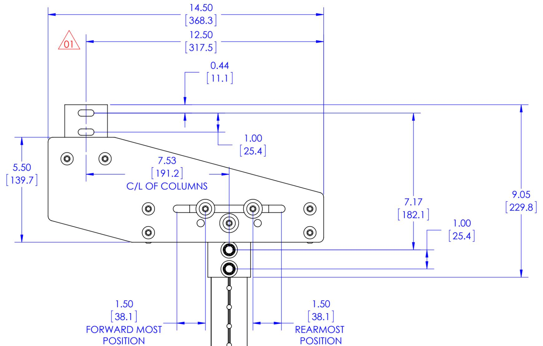
OFFSET SHOULD BE PUT IN THE FORWARD MOST POSITION FOR SCREENS LESS THAN 2.5" DEEP
