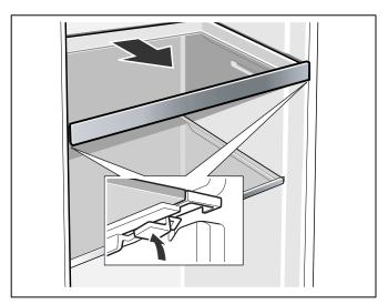
Rigole d'écoulement de l'eau de dégivrage Avec un bâtonnet de ouate ou un objet similaire, nettoyez régulièrement la rigole et le trou d'écoulement afin que l'eau de dégivrage puisse s'écouler.
