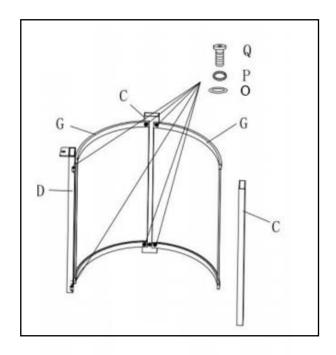
2. Sécuriser le côté (G), le poste arrière (C), le côté d'allumage (F), le côté avant gauche (E) avec 6 pièces in x boulons 20 mm (Q), 6 bague à ressort (P), 6 rondelle plate (O).
