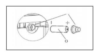
9. Coloque el cilindro de 20 libras en el cuerpo principal y apriételo como se muestra a la derecha, por lo que el cilindro de gas no puede moverse y caerse, cerrar la puerta, cubrir la hoguera con cubierta de PVC (L) cuando no se utiliza para protegerlo De los elementos o cuando la hoguera se enfríe COMPLETAMENTE después del uso.
