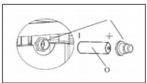
9. Mettre la bouteille de 20-livre dans le corps principal et serrer-la comme affiché à droite, ainsi la bouteille de gaz ne peut pas se bouger et tomber, fermer la porte, couvrir le feu de foyer avec le couvercle en PVC (L) en cas de non usage pour le protéger des éléments ou lorsque le foyer est COMPLETEMENT frais après l'usage.
