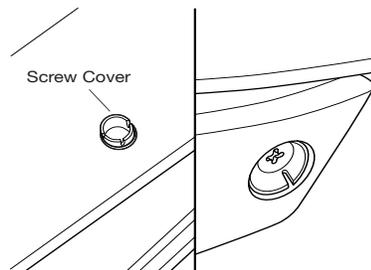
6. Instale las 4 cubiertas del tornillo y alinee la saliente con la muesca.
