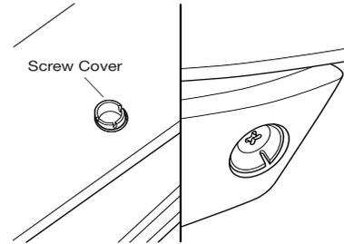
6. Installer les 4 vis avec capot et s'assurer que la bosse de chaque capot entre dans le retrait du trou à vis.
