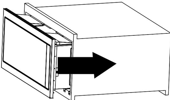
4. Ajuster doucement le four à micro-ondes au centre de l'ouverture d'encastrement de l'armoire.
