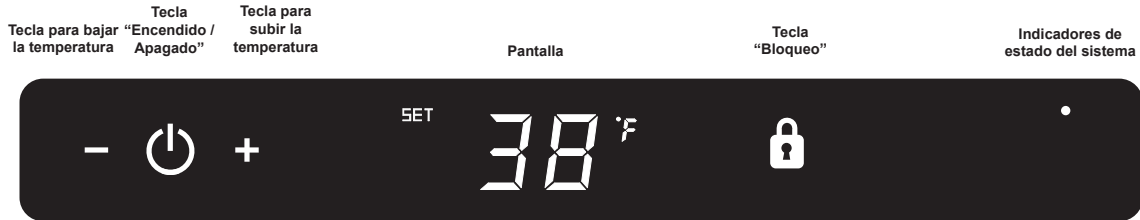
Figura 12 Control electrónico para una sola zona
