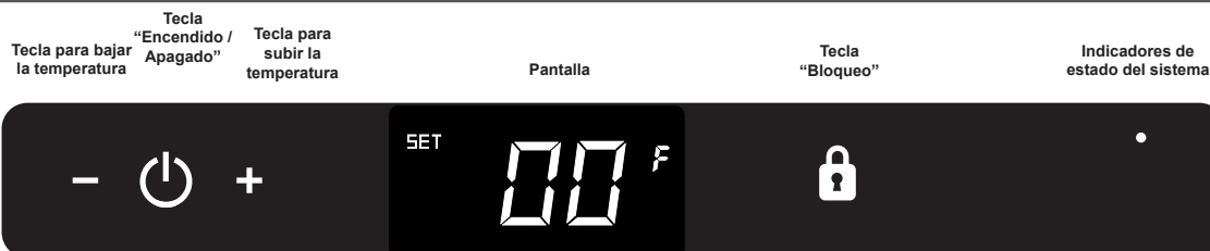
Figura 12 Control electrónico para una sola zona
