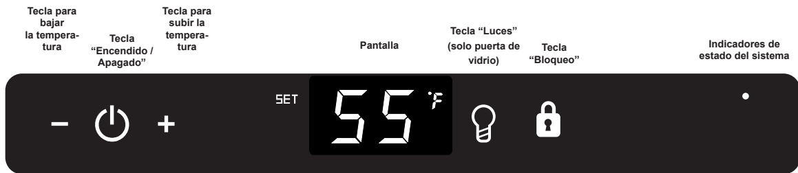
Figura 10 Control electrónico para una sola zona
