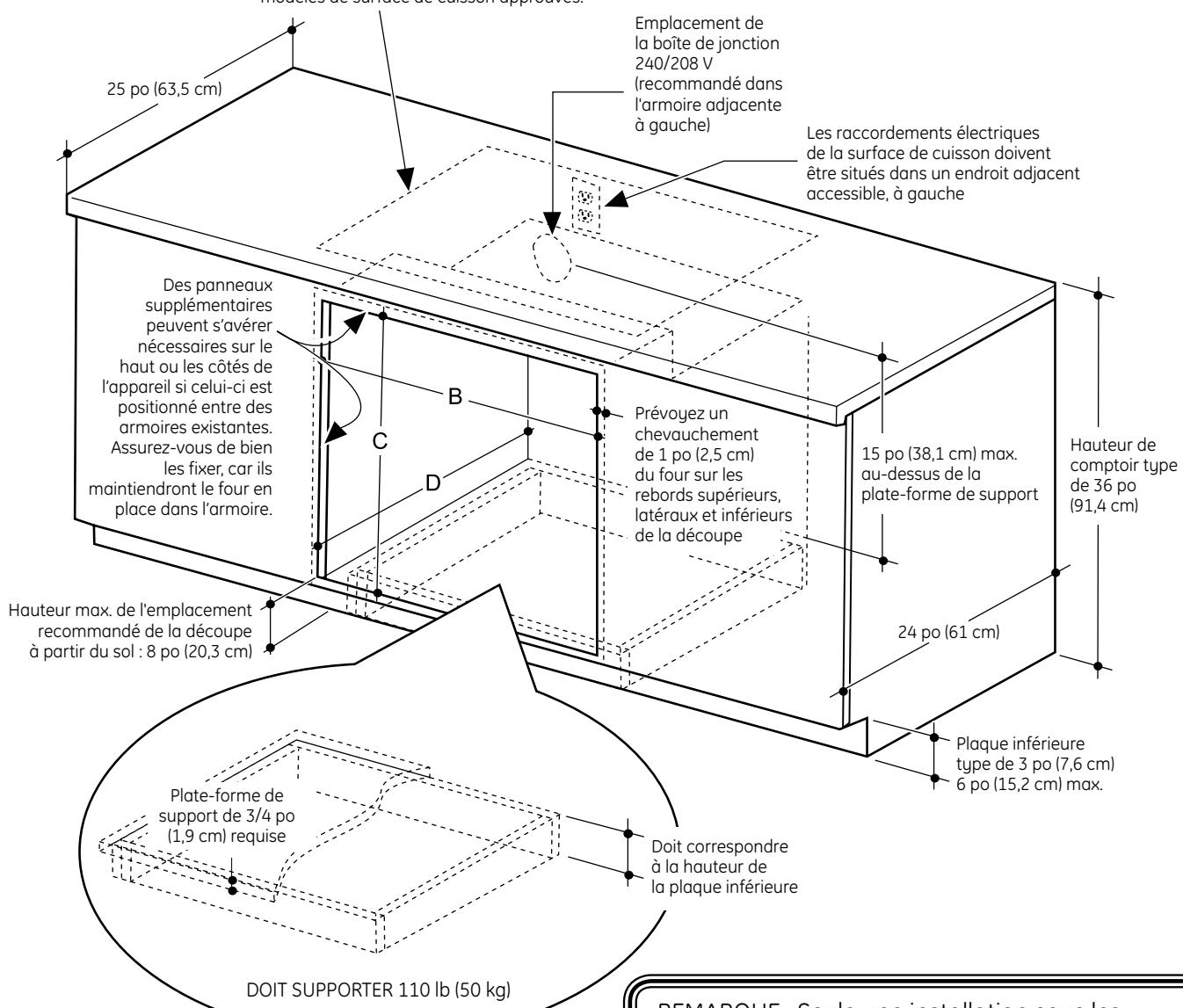
**REMARQUE :** Seule une installation sous les modèles spécifiques indiqués sur l'appareil a été approuvée pour ce four.
