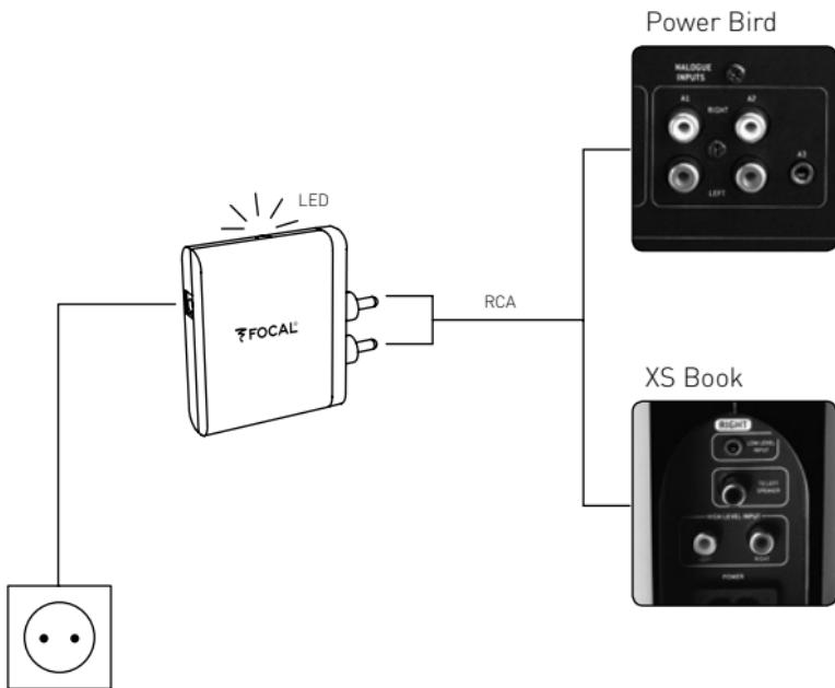
**Información :** Si utiliza Powerbird en posición horizontal puede directamente conectar el APTX con receptor sin necesidad de utilizar el cable RCA.
