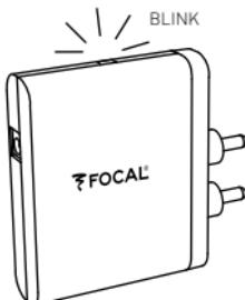
La LED clignote : Le récepteur est alimenté et n'est pas associé à un appareil compatible bluetooth.
