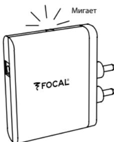
Светодиод мигает: Адаптер включен, но bluetooth-соединение с Вашим устройством не установлено. Вы можете подключить новое устройство
