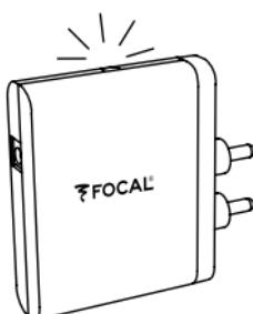
Светодиод горит постоянно: Адаптер включен, bluetooth-соединение с Вашим устройством установлено. Можно прослушивать музыку. Для подключения нового устройства, необходимо разорвать bluetooth-соединение с уже подключенным устройством.
