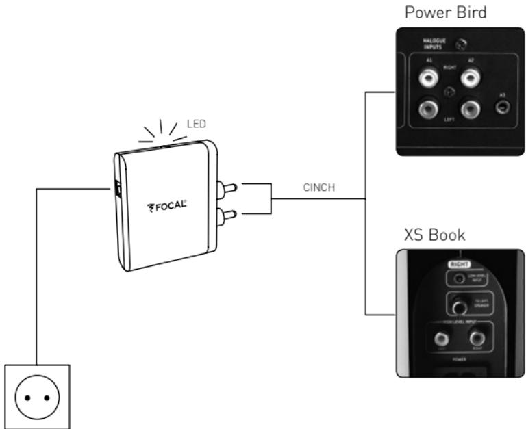
**Hinweis:** Bei horizontaler Aufstellung des Power Bird können Sie den aptX-Receiver ohne Cinch-Kabel direkt an den Anschlüssen A1 und A2 anschließen.
