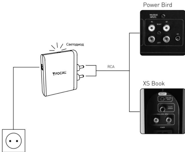
**Информация:** При использовании Powerbird в горизонтальном положении, возможно непосредственное подключение aptX приемника к RCA разъемам Powerbird, без использования кабеля RCA.
