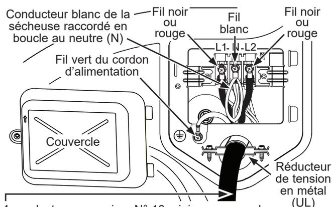
4 conducteurs en cuivre N° 10 minimum ou cordon d'alimentation de 120/240 V 30 A pour sècheuse muni de cosse ouvertes ou à anneau (non fourni).
