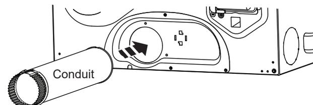
**REMARQUE :** Nous vous recommandons fortement d'utiliser un conduit d'évacuation rigide et en métal. Si les conduits flexibles de métal sont installés, ils doivent être homologué UL, pas de plastique.
