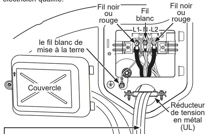
3 conducteurs en cuivre N° 10 minimum ou cordon d'alimentation de 120/240 V 30 A pour sècheuse muni de cosse ouvertes ou à anneau (non fourni).
