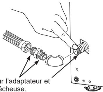
**C** Serrez le raccord du tuyau de raccordement souple à l'aide de deux clés à molette.
