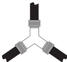
4. Insérez la grille de filtre dans le raccord du boyau d'arrivée de **la laveuse**. Si une rondelle plate en caoutchouc est déjà en place, retirez-la avant d'installer la grille de filtre. Raccordez ce raccord à une extrémité mâle du connecteur en « Y ». Resserrez à la main jusqu'à ce qu'il soit bien serré.
