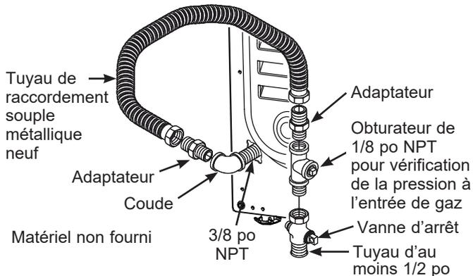
**B** Fixez le tuyau de raccordement métallique souple à l'adaptateur.
