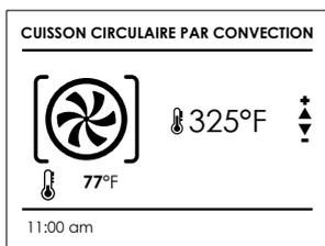
Lors du préchauffage, la température actuelle est indiquée dans l'afficheur à côté de l'icône de préchauffage. Lorsque la température réglée est atteinte, une tonalité est émise et la valeur de température disparaît de l'afficheur.
