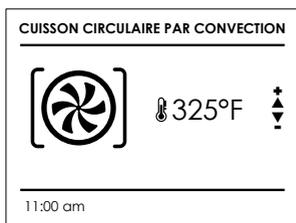
Utilisez ▲ ▼ pour régler la température avant d'appuyer sur ✓ pour commencer la cuisson.
