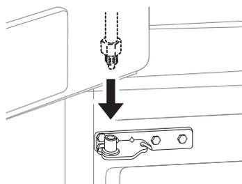
**2** Fixez la charnière **1** sur le verrou à levier de la charnière **2** et insérez-la. Faites pivoter le levier **3** dans le sens horaire pour fixer la charnière.
