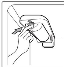
**REMARQUE:** Le remplacement du filtre à eau entraîne l'écoulement d'une petite quantité d'eau (environ 1 once ou 25 cc). Placez une tasse sous l'extrémité avant du couvercle du filtre à eau pour recueillir tout écoulement d'eau. Tenez le filtre à eau à la verticale, une fois qu'il est retiré, pour empêcher tout écoulement d'eau du filtre à eau.
