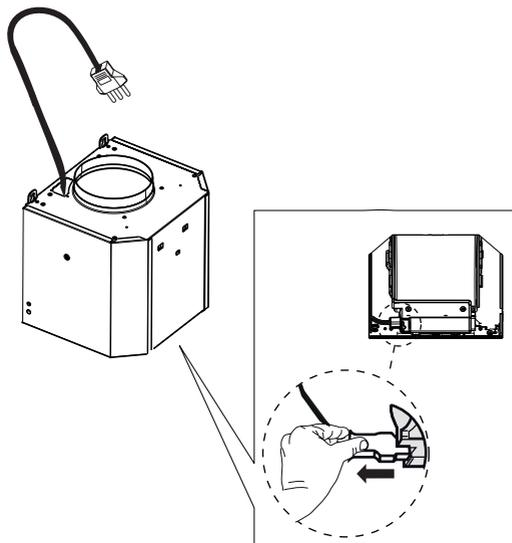
Pour les hottes équipées d'un Easy Cube, débranchez le câble d'alimentation du moteur à l'intérieur du boîtier du moteur.
