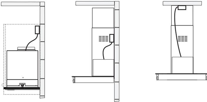
Le boîtier de connexion peut être installé sur le mur, dans une armoire ou au plafond, en fonction du modèle de hotte et de l'alimentation électrique de la maison.
