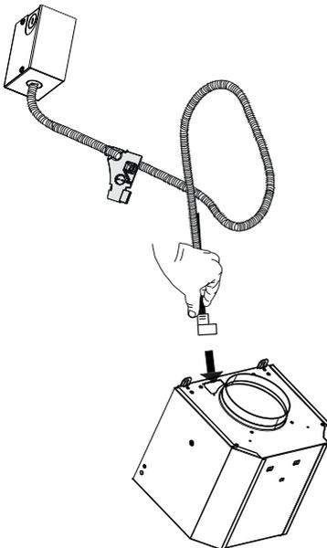
Pour les hottes équipées d'un Easy Cube, insérez le connecteur du moteur dans l'ouverture de câblage d'où le fil précédent a été enlevé.
