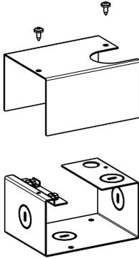
Ouvrez le couvercle du boîtier de connexion en dévissant les deux vis.
