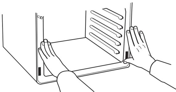
4. Fixer solidement le four à l'armoire à l'aide des deux vis autotaraudantes de 4 x 25 mm fournies. Insérer les vis à travers les trous des glissières de montage. Ne pas serrer excessivement les vis.
