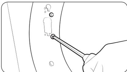
8. Réinsérez les deux vis qui fixaient le support du dispositif de fermeture dans les mêmes trous de vis, puis serrez-les.
