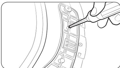
10. Insérez la vis que vous venez de retirer dans l'autre trou de vis, à l'arrière de la charnière du hublot, puis serrez-la.
