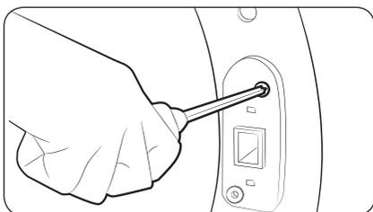
12. Poussez le support du dispositif de fermeture dans le découpage, de l'autre côté de l'ouverture du hublot. Insérez les vis, puis serrez-les comme indiqué.
