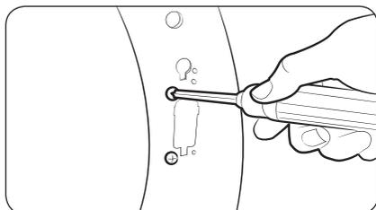
5. Retirez les deux vis qui se trouvent au-dessus et en dessous du découpage à l'avant du châssis.
