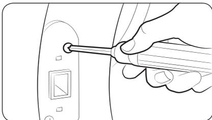
7. Retirez les deux vis qui tiennent le support du dispositif de fermeture en place, puis enlevez le support du dispositif de fermeture.
