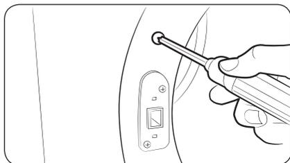
6. Retirez les deux vis qui se trouvent au-dessus et en dessous du support du dispositif de fermeture, sur le côté opposé de l'ouverture du hublot.
