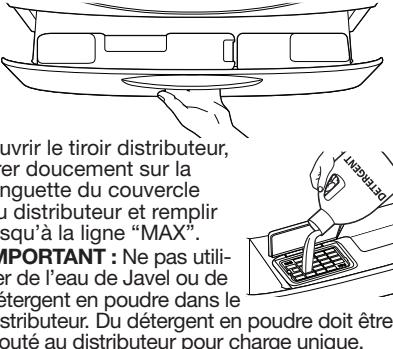
**IMPORTANT :** Ne pas utiliser de l'eau de Javel ou de détergent en poudre dans le distributeur. Du détergent en poudre doit être ajouté au distributeur pour charge unique.
