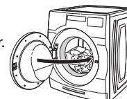
**IMPORTANT :** Pousser entièrement la charge dans la laveuse. S'assurer qu'aucun article ne se trouve sur le joint en caoutchouc pour éviter de le coincer entre le joint et la porte en verre.
