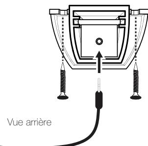
Câble de la télécommande passe audio, ne le font pas parallèles à câbles d'alimentation. Raccordez le cordon de raccordement de 1/8 pouces [3.5mm] alimentant la télécommande CXARC et l'entrée « Basses à distance » sur l'amplificateur.
