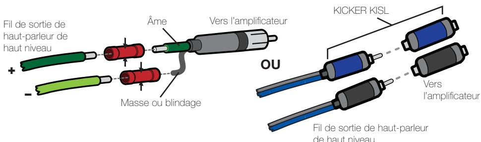
Installez un fusible dans un rayon de 45 cm (18 po) de la batterie directement sur le câble d'alimentation raccordé à votre amplificateur. Si vous devez retirer l'amplificateur après l'avoir installé dans le véhicule, débranchez toujours le fil de masse en dernier, en procédant à l'opposé de l'installation.
