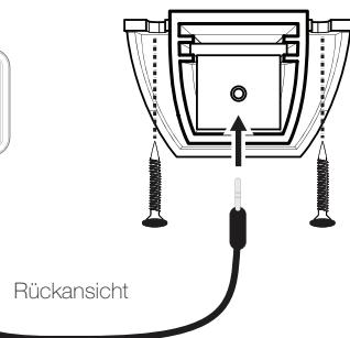
Stecken Sie das mitgelieferte 1/8 Zoll [3.5mm] Patchkabel in den CXARC-Remote-Regler und in die "Remote-Bass"-Steckerbuchse am Verstärker.
