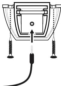
Conecte el cable de extensión de 1/8 pulgadas [3.5mm] suministrado al control remoto CXARC y a la entrada de grave remoto en el amplificador. Cable de control remoto de audio pasa, no se ejecutan en paralelo a los cables de alimentación.
