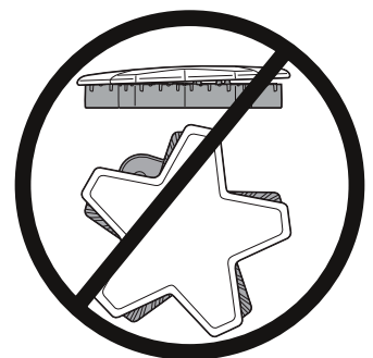
Tapa del quemador incorrecta
