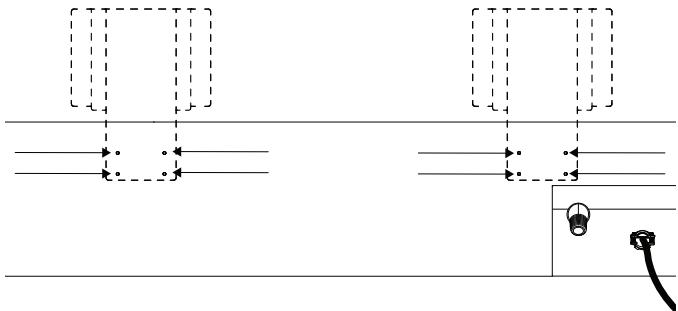
4. Coloque la tapa de la consola trasera en la parte superior y fíjela con dos tornillos de ½ pulg. (12,7 mm).
