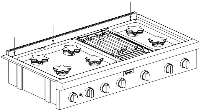
2. Deslice los soportes entre los dos paneles traseros de los armazones de las estufas.
