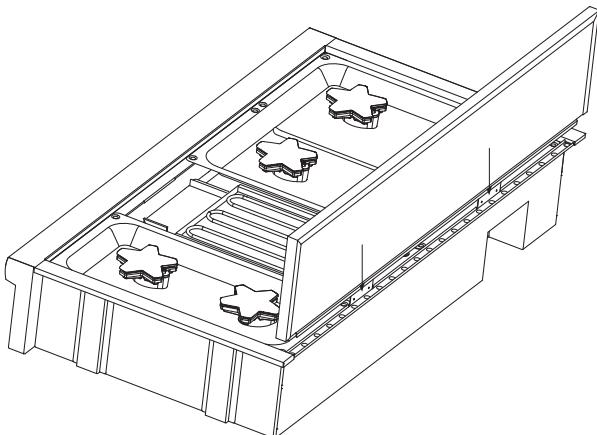
3. Fije la parte delantera de la consola trasera a la estufa con tres o cuatro tornillos e ½ pulg. (12,7 mm).
