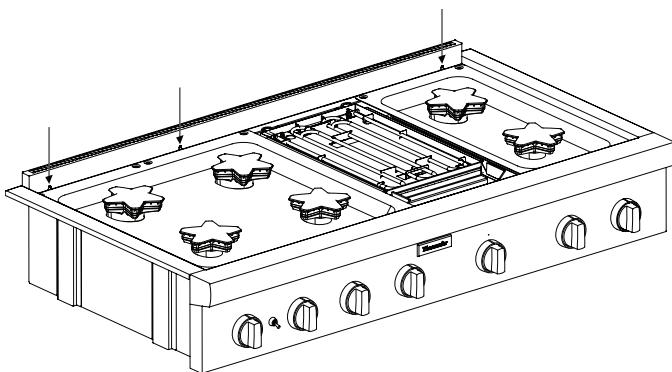
2. Faites glisser les pattes des supports entre les deux panneaux arrière des boîtiers des cuisinières. Fixez chaque support avec quatre vis de 1½ po (38 mm).
