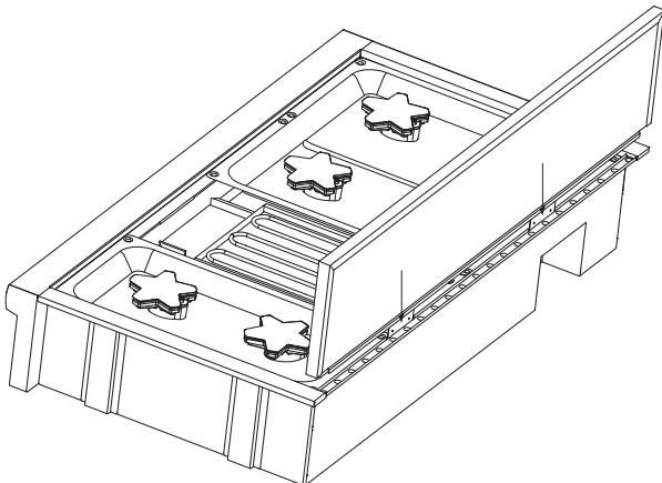
3. Fixez l'avant de la plaque de protection à la cuisinière avec trois ou quatre vis de ½ po (12,7 mm).
