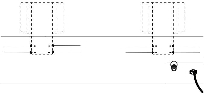
4. Placez le couvercle de la plaque de protection sur le dessus et fixez-le en place à l'aide de deux vis de ½ po (12,7 mm).
