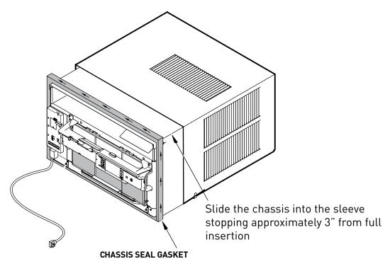
NOTE WHEN INSTALLING THE CHASSIS SEAL GASKET, BEGIN AT EITHER BOTTOM CORNER AND GO UP THE SIDE & ACROSS THE TOP & DOWN THE OPPOSITE SIDE.
