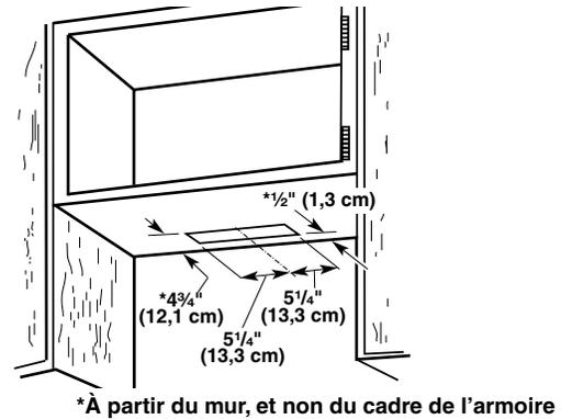
**Découpage d'une ouverture circulaire sur la face inférieure du sommet de l'armoire :**
