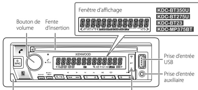
Touche de détachement **KDC-X303 / KDC-BT375U / KDC-BT33 / KMR-D375BT** : S'allume quand la connexion Bluetooth est établie.
