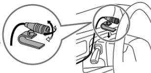
Fixez si nécessaire en utilisant des serre-câbles (non fourni).
