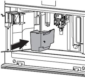
**INSERT WATER OUTLET (insérer la sortie d'eau)**
