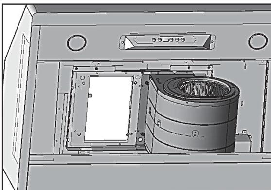
5. Installez le ventilateur préalablement enlevé de l'un des côtés de la plaque du ventilateur double et fixez-le en place à l'aide des quatre (4) vis enlevées à l'étape 2.
