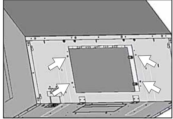
8. De corps de la hotte à l'intérieur, la position plaque de couverture supérieure en haut du corps de la hotte. De corps de la hotte à l'extérieur, fixez la plaque supérieure de la couverture en haut du corps de la hotte à l'aide (4) 3/16 x 3/8 vis.
