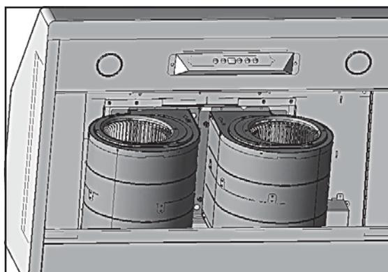
6. Installez le ventilateur de la trousse PBD-1200A de l'autre côté de la plaque du ventilateur double et fixez-le en place à l'aide de quatre (4) vis 3/16 x 3/8.
