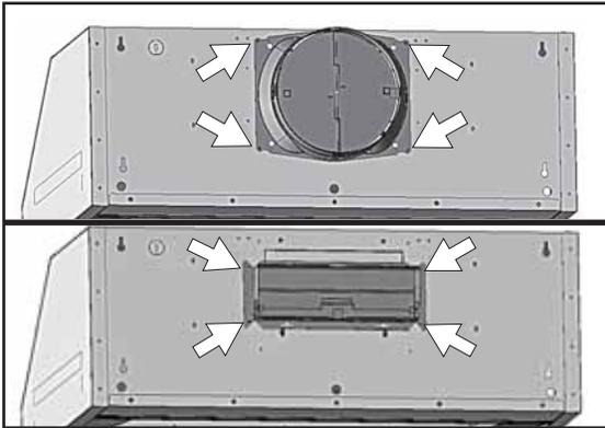
7. Fixez le collier de conduit circulaire de 8" ou rectangulaire de 3-1/4"x10" à l'arrière du bâti de la hotte à l'aide de quatre (4) vis M3.5 x 8.
