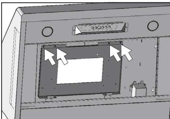
3. Enlevez les quatre (4) vis de l'intérieur de la hotte qui retiennent la plaque du ventilateur simple au bâti. Retirez la plaque du ventilateur simple du bâti de la hotte.
