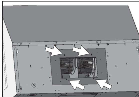
2. Enlevez les quatre (4) vis de la partie supérieure de la hotte qui retiennent le ventilateur à la plaque du ventilateur simple. Retirez le ventilateur du bâti de la hotte.
