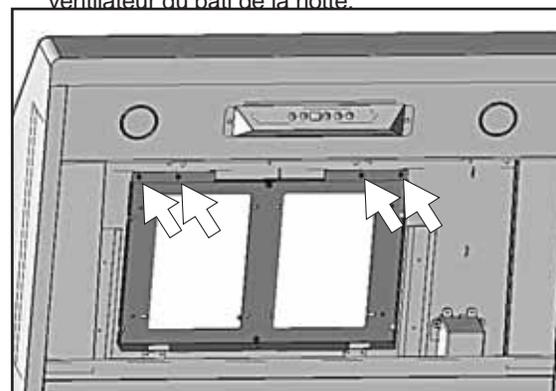
4. Installez la plaque du ventilateur double de la trousse du PBD-1200A dans le bâti de la hotte. Fixez-la en place à l'aide des quatre (4) vis enlevées à l'étape 3.
