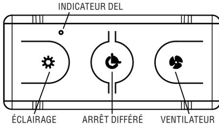
**Bouton éclairage** – Lorsque l'éclairage de la hotte est ÉTEINT, ce bouton ALLUME l'éclairage à l'intensité la plus faible. Si vous appuyez de nouveau, les lumières passent à l'intensité suivante. Lorsque l'éclairage est à la plus forte intensité, appuyez sur ce bouton pour éteindre l'éclairage.
