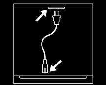
PLUG THE POWER CORD INTO THE UNIT AND WALL OUTLET. THE TURNTABLE WILL AUTOMATICALLY BOOT UP. ONCE THE ILLUMINATED CONTROL KNOB BEGINS FLASHING GREEN. TURNTABLE IS READY TO CONNECT TO A NETWORK
