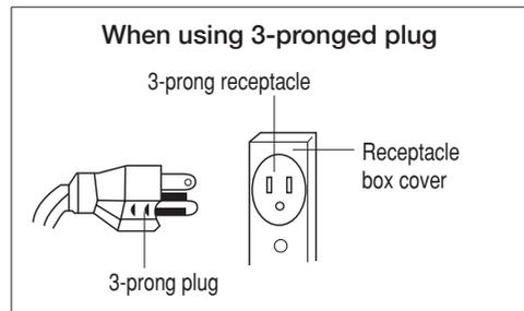
THE CANADIAN ELECTRICAL CODE DOES NOT ALLOW THE USE OF THE GROUNDING ADAPTOR.
