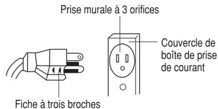
LE CODE CANADIEN DE L'ÉLECTRICITÉ NE PERMET PAS L'UTILISATION D'UN ADAPTEUR DE MISE À LA TERRE.
