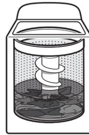
La laveuse a été conçue et optimisée pour fournir un nettoyage en profondeur en utilisant moins d'eau afin d'économiser l'énergie et les ressources. À mesure que la laveuse imbibé et déplace la charge, les articles se tassent dans le panier. Ceci est normal et ne signifie pas que l'on doit rajouter des articles. **IMPORTANT :** Il n'y aura pas de panier d'eau plein comme avec les machines à laver plus anciennes et moins efficaces. Il est normal qu'une partie de la charge dépasse du niveau d'eau.
