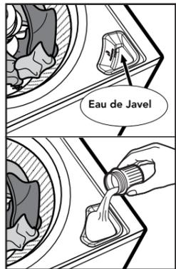
Ne pas remplir excessivement le distributeur, diluer le produit ou utiliser plus d'une tasse (236 mL). Ne pas utiliser d'agent de blanchiment sans danger pour les couleurs ni de produit Oxi avec un programme utilisant de l'eau de Javel.
