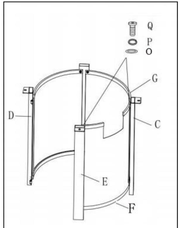
3. Asegure el soporte del cilindro (I) y el poste delantero izquierdo (E), el poste delantero derecho (D), el poste trasero (C) con 4 tornillos de  $\frac{1}{4}$  x 20 mm (S), 4 arandela de resorte (Q), 4 arandela plana (P), como se muestra a la derecha.
