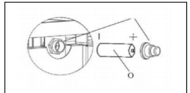
9. Coloque el cilindro de 20 libras en el cuerpo principal y apriételo como se muestra a la derecha, por lo que el cilindro de gas no puede moverse y caerse, cerrar la puerta, cubrir la hoguera con cubierta de PVC (L) cuando no se utiliza para protegerlo De los elementos o cuando la hoguera se enfríe COMPLETAMENTE después del uso.
