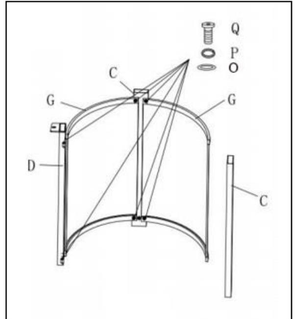
2. Asegure el lado (G), el poste trasero (C), el lado de encendido (F), el lado izquierdo delantero (E) con 6 tornillos  $\frac{1}{4}$  x perno 20 mm (Q), 6 arandela de resorte (P), 6 arandela plana (O).
