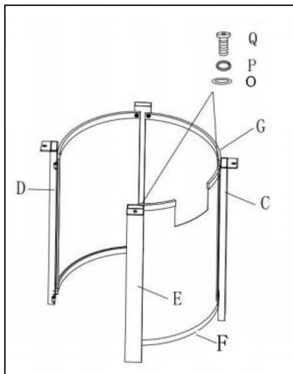
3. Sécuriser le support de bouteille (I) et le poste avant gauche (E), poste avant droite(D),poste arrière (C) avec 4 pièces ¼ in x boulons 20 mm (Q), 4 bague à ressort (P), 4 rondelle plate (O), juste comme affiché à droite.
