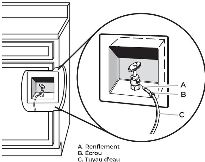
3. Placer l'extrémité du tube dans un seau et OUVRIRE le robinet d'arrêt.
