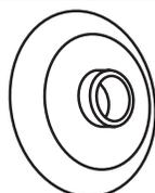
Rondelle à épaulement (utiliser avec une vis à tête hexagonale pointue) W10471946 (4)
