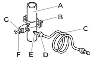
6. Fixer le robinet d'arrêt sur la canalisation d'eau froide avec la bride de tuyau. Veiller à bien insérer l'extrémité de sortie dans le trou de 1/4 po (6,35 mm) de la canalisation d'eau; veiller à placer correctement le joint sous la bride du tuyau. Serrer l'écrou de serrage. Serrer lentement et uniformément les vis fixant la bride de tuyau sur le tuyau afin d'assurer l'étanchéité du joint. Ne pas serrer excessivement.
