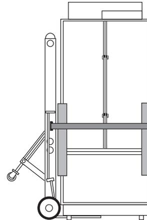
2. Placer des bouts du carton d'expédition sur le plancher lorsqu'on fait rouler le chariot et le réfrigérateur pour les faire entrer dans le domicile. Approcher le réfrigérateur près de l'ouverture d'encastrement.
